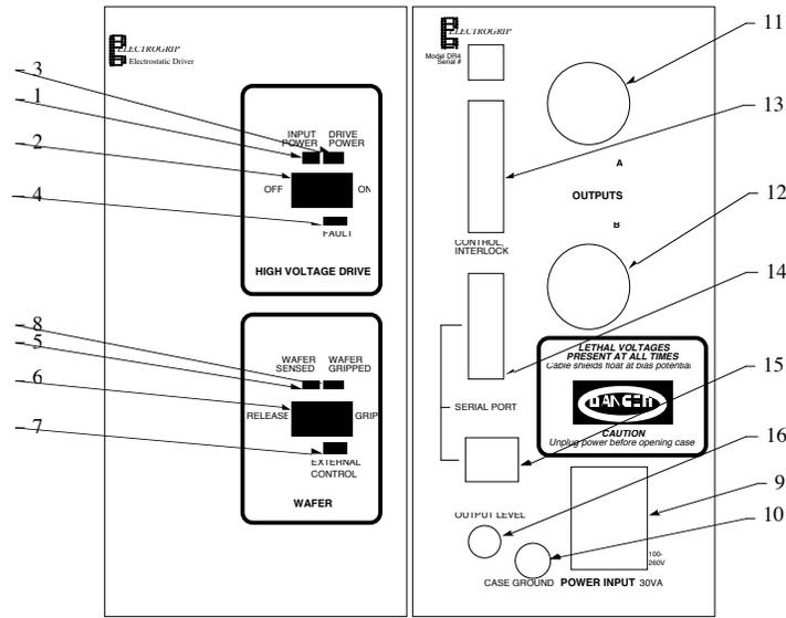
Fig. 3 Controls (vertical)
