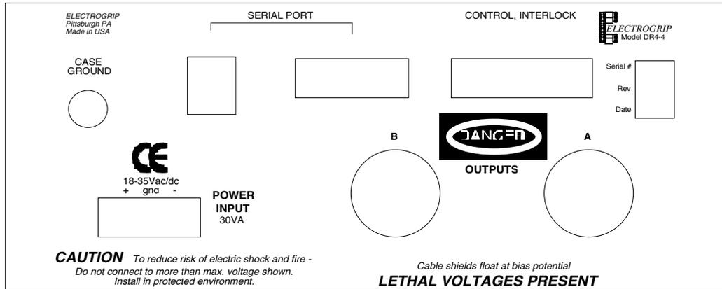
Fig. 2 Rear Panel (low volt input)
